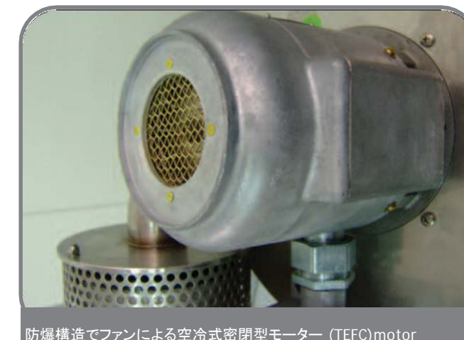
防爆構造でファンによる空冷式密閉型モーター (TEFC) motor
